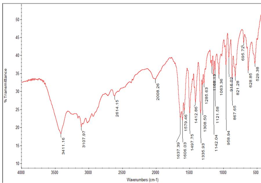
Fig. 3: FTIR spectrum of LHSC crystal
